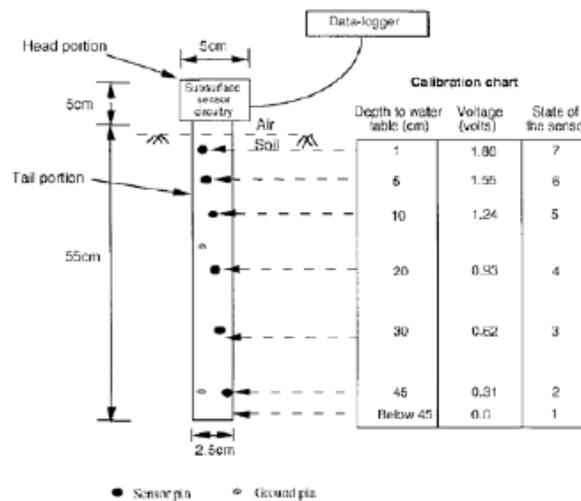
Figur 2. "Subsurface sensor" för att mäta vattennivå under och nära markytan. Utspänningen ändras beroende på hur många mätpunkter (stift) finns under vattennivån och därmed kan spänningen omvandlas till vattennivå (Srinivasan *m.fl.*, 2000).
